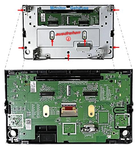
2 Die 7 Schrauben (rot Pfeile) an der Rückseite des Monitors ausdrehen und das Rückenblech demontieren um den Hauptplatine-Flexleitungssockel mit der Werks-Bildsignalleitung freizulegen.
