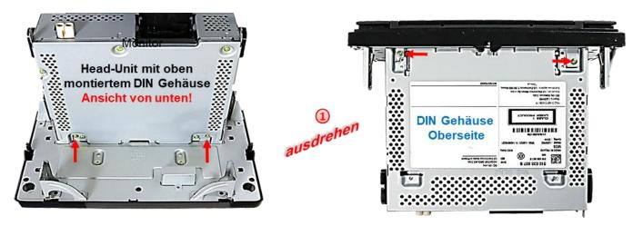
Die 2 **äußeren** Schrauben an Unterseite der Head Unit (rote Pfeile) und die beiden Schrauben an der Oberseite der Head Unit (rote Pfeile) ausdrehen, die Head Unit vom Monitor trennen und beiseite legen.
