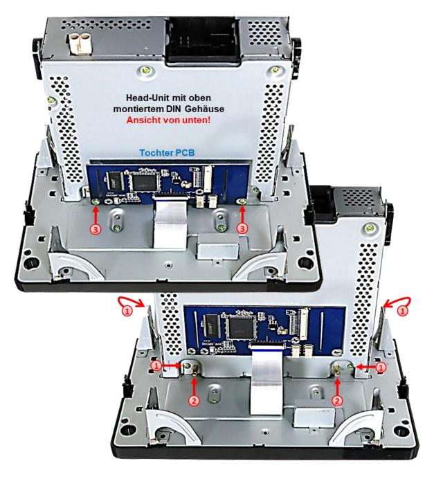
1 Die Head Unit wieder vorsichtig am Monitor einstecken und mit den 4 Schrauben ober- und unterhalb der Head Unit befestigen.
