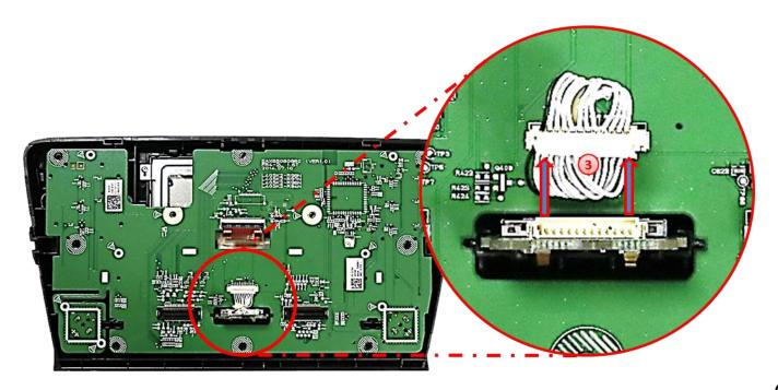
3 Die 12-Pin Buchse vom 12-Pin Stecker am SD Karten Steckplatz abstecken (platinenseitig montiert lassen).
