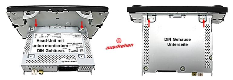
Die beiden **äußeren** Schrauben an Unterseite der Head Unit (rote Pfeile) und die beiden Schrauben an der Oberseite der Head Unit (rote Pfeile) ausdrehen, die Head Unit vom Monitor trennen und beiseite legen.
