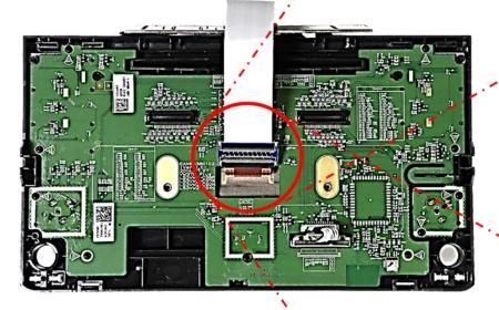
Um Kurzschlüsse durch Vibrationen auszuschließen muss der Flexleitungsverbinder rundherum mit einer Lage Gewebeband isoliert werden, wie in nebenstehendem Bild zu sehen.
