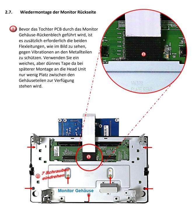
2 Das Monitor Rückenblech anhand der 7 Schrauben am Monitor befestigen.
