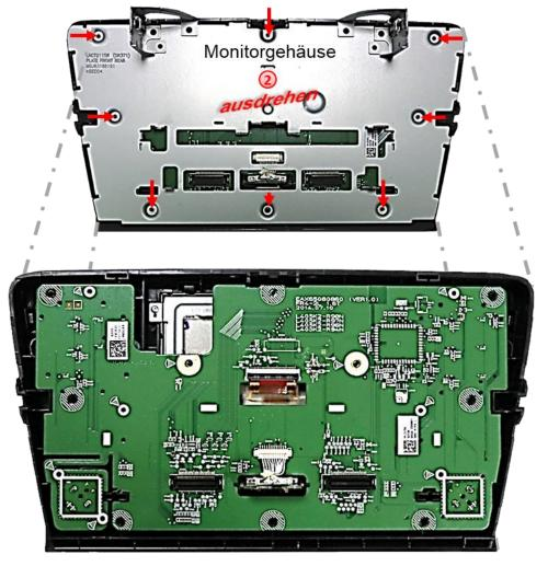
Die 8 Schrauben (rot Pfeile) an der Rückseite des Monitors ausdrehen und das Rückenblech demontieren um den Flexleitungssockel der Hauptplatine mit der Werks- Bildsignalleitung freizulegen.
