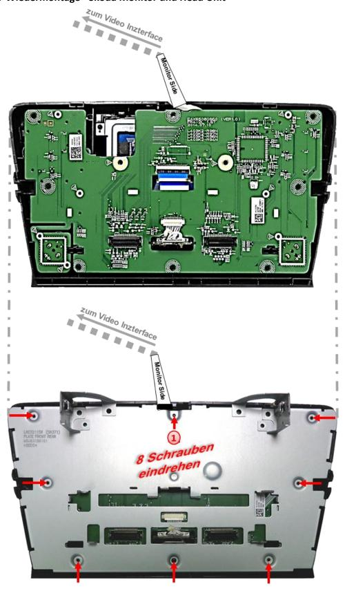
Das Bildsignalkabel an geeigneter Stelle aus dem Gehäuse herausführen und das Monitor-Rückenteil anhand der 8 Schrauben wieder befestigen.
