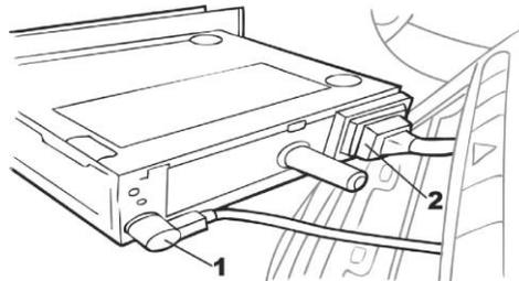
Nachdem das Hauptkabel abgeklemmt ist, verbinden Sie das Dension-Kabel mit dem fahrerseitigen Kabel und dem Autoradio. Hier sind die möglichen Situationen:
