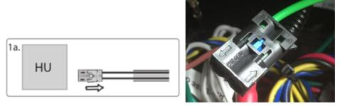
Dann drücken Sie den mittleren Clip vom Gehäuse und entfernen Sie den Lichtleiter der mit Signaleingang gekennzeichnet ist.
