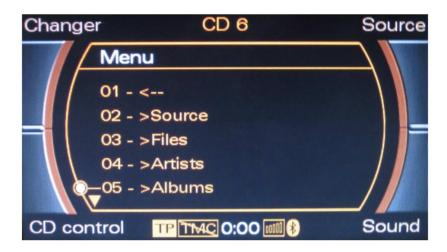
Sie gelangen ins Gateway-Hauptmenü, indem Sie "Changer" mit der oberen linken Taste auswählen und danach mit dem Drehknopf "Menü" auswählen.
