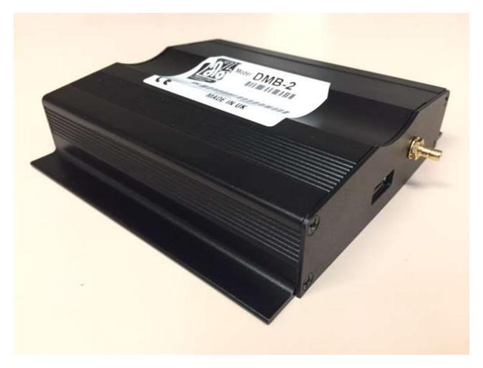
Das D-MB-2 ist eine DAB+ Lösung für Mercedes Benz mit NTG2.5 COMAND, NTG3, NTG4 COMAND, NTG4-W212 COMAND/Audio-20-CDC/Audio-50-APS und NTG4.5 COMAND/Audio-20CDC Systemen. (Audio 20 mit einer einzelnen Festplatte wird nicht unterstützt, da kein Lichtwellenleitersystem vorhanden ist.)
