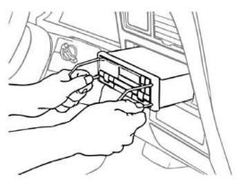
Entfernen Sie zuerst sorgfältig das vorhandene OE Head Unit gemäss den Anweisungen des Herstellers und verwenden Sie das richtige Werkzeug dazu. In einigen Fällen benötigt das Entfernen des Head Units auch das Entfernen des Panels. Wir empfehlen Ihnen deshalb, den Händler oder Installateur Ihres Fahrzeuges zu kontaktieren.
