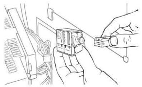
Wenn das Hauptkabel entfernt ist, verbinden Sie zuerst das mitgelieferte Dension-Kabel mit dem Original-Kabelbaum des Herstellers.
