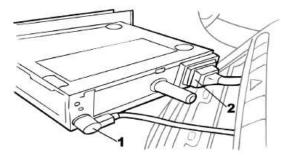
Wenn Sie das Head Unit entfernt haben, trennen Sie das Antennenkabel (1) und lösen Sie anschliessend den Hauptverdrahtungsstecker vom Head Unit (2). Dies wird sich wiederum je nach Marke und Hersteller unterscheiden.
